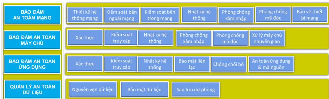
Hình 43 Mô hình yêu cầu kỹ thuật đảm bảo an toàn thông tin
